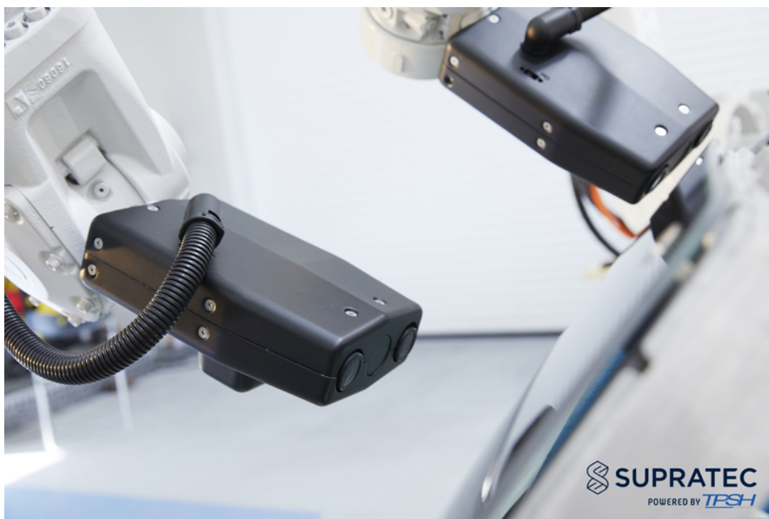
eScan - Système de mesure confocale 100% robotisé et automatisé pour la détection et caractérisation des déformations de pièces
